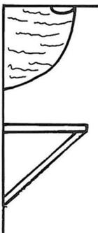
**Bei durchgängigen „Kotbrettern“ (über die ges. Hausbreite) ist es günstiger die Konsolen (Abb. 6a) anzufertigen. Dadurch wird verhindert, daß sich Schwalben unter dem Kotbrett ansiedeln**
