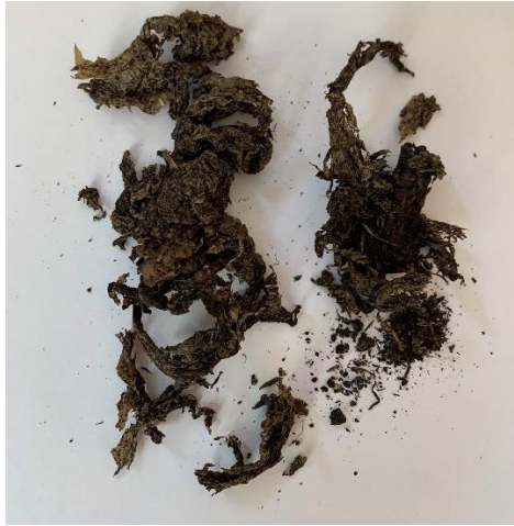
Abbildung 7: Kompostierte BAW-Beutel Mater-Bi® (Standard) der Wintercharge 2022 mit biologischer Vorbehandlung in der Anlage 2
