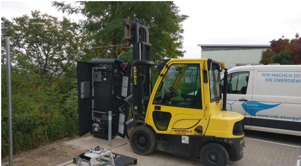
Abbildung 12: Aufbau der DC-Ladesäule
