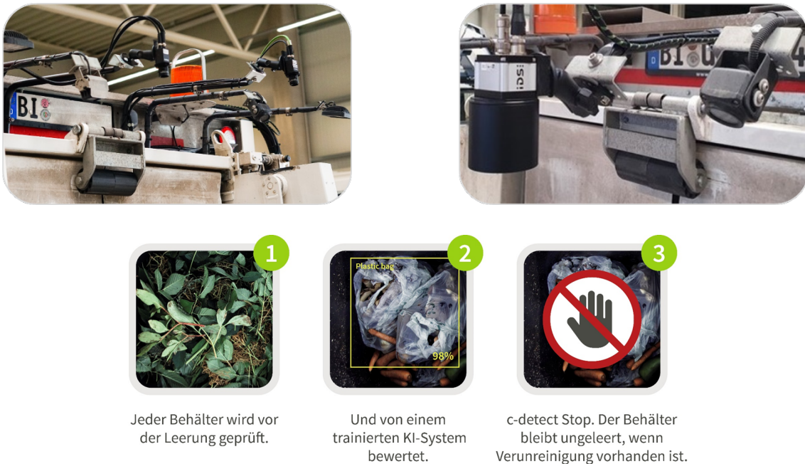
Abbildung 3: Selbsterlernendes Fremdstofferkennungssystem c-detect TopView
