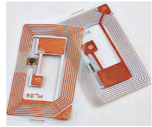
Abb. 73: Innenleben einer RFID-Card.
