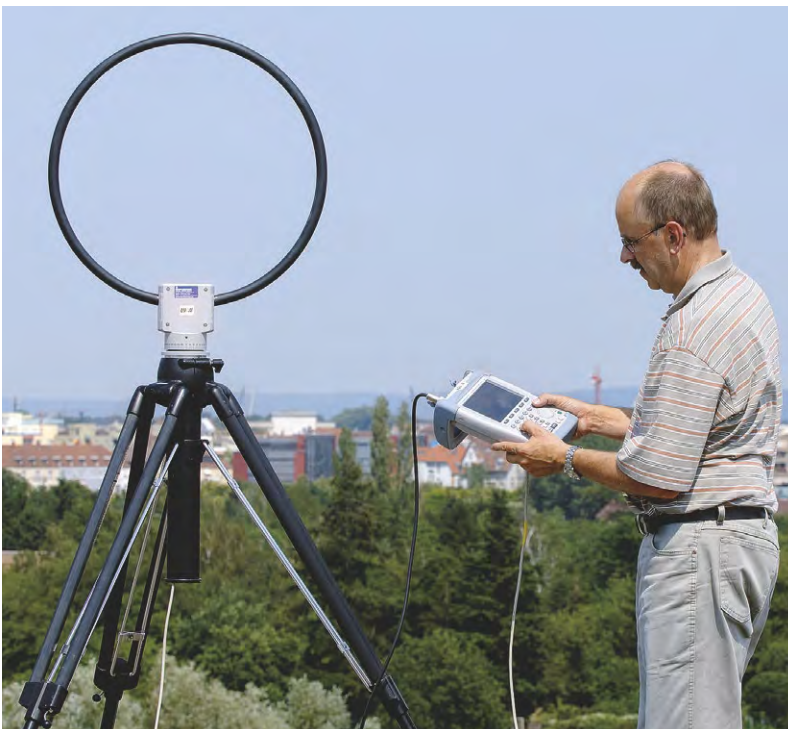
Abb. 79: Messung von Funkwellen: Mit Hilfe einer Rahmenantenne werden die Signale von Rundfunksendern (Langwelle, Mittelwelle, Kurzwelle) erfasst.
