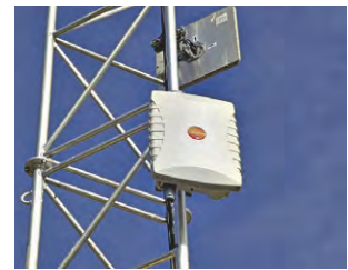
Abb. 69: WLAN-Richtfunksystem mit Flachantenne (5,8 GHz).
