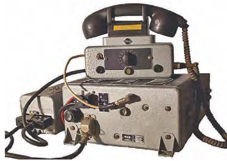
Abb. 48: A-Netz-Autotelefon der Firma TE-KADE aus dem Jahre 1961.
