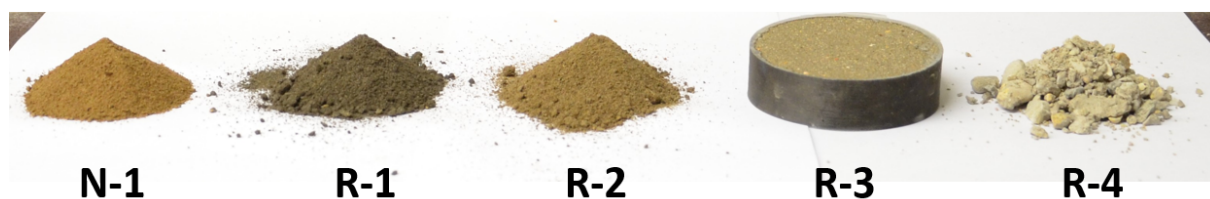
Abbildung 6: Ausgangsmaterial N-1 und die behandelten Böden R-1, R-2, R-3 und die Betonmischung R-4 nach Aufbrechen.
