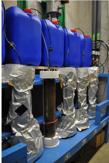
Abbildung 16: Säulenversuchsstand mit darüberstehenden Eluatsammelbehältern (links) und Eluatproben aus verschiedenen Säulenversuchen (rechts).
