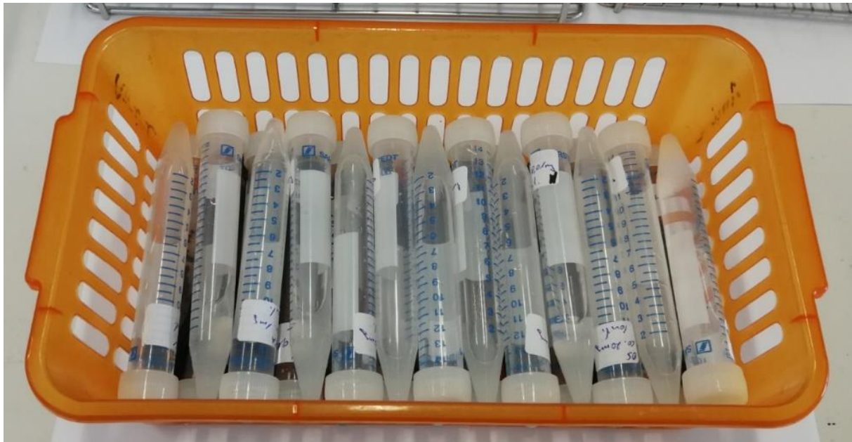
Abbildung 61: Zur Beladung der Adsorbentien wurden in 15 mL-Zentrifugenröhrchen aus PP, jeweils 1 g Ionenaustauscher oder 1 g Kornaktivkohle mit 10 mL PFAS-Lösung ( 10 \mu\text{g abs. je Substanz} ) durch Schütteln für 4 h beladen.
