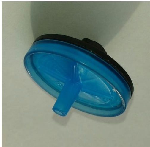
Abbildung 57: Spritzenvorfilter CHROMAFIL® GF/RC, bestehend aus einem eingangsseitigen schwarzen Teil (Glasfaserfilter, Porenweite: 0,7 µm) und einem darunter liegenden blauen Teil (Membranfilter aus regenerierter Cellulose, Porenweite: 0,45 µm).
