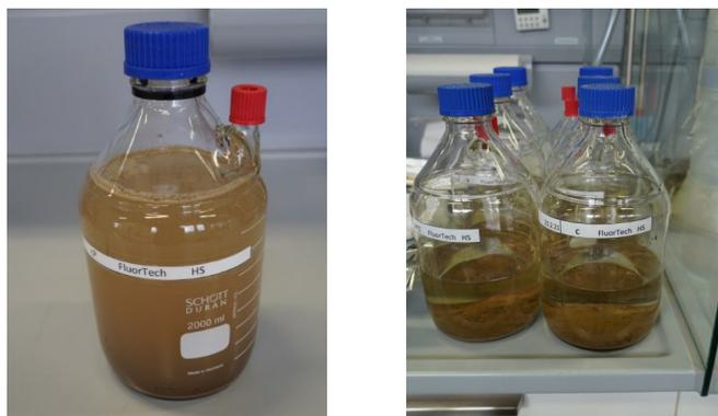
**Abbildung 26:** Mikrokosmos zur Untersuchung der Transformation von Vorläufersubstanzen aus Papierhilfsmitteln.
