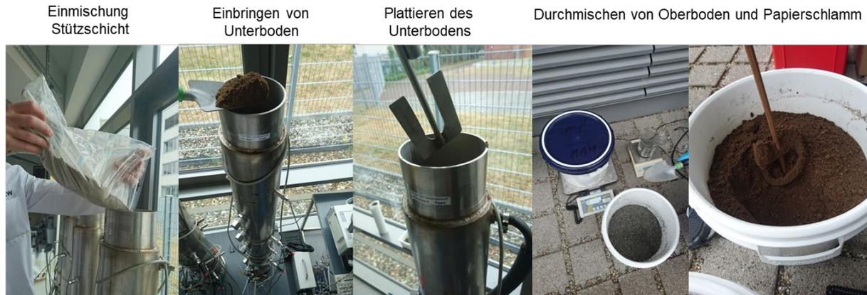
**Abbildung 17:** Vorbereitung der Säulenversuche
