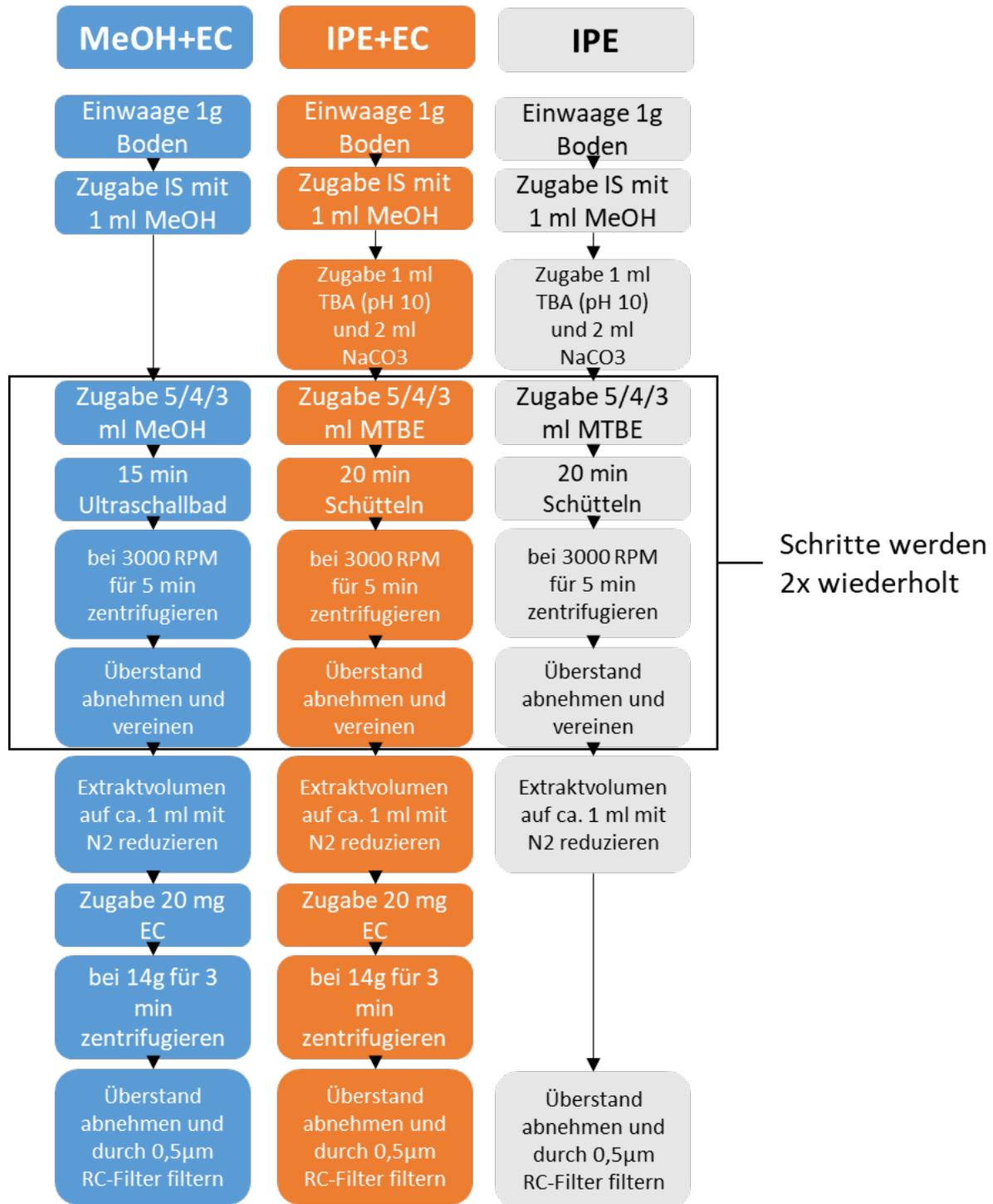
Abbildung 80: Protokolle der drei angewandten Methoden zur Extraktion von PFAS in Bodenproben.
