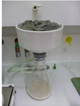
**Abbildung 3:** Herstellung der dotierten Papierschlämme.
