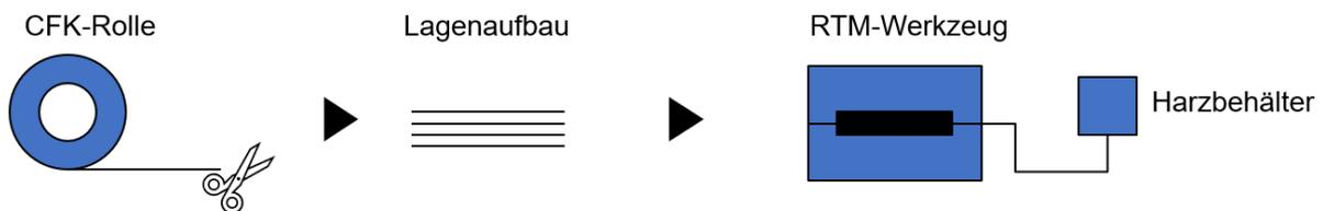
Abbildung 1: Skizzierung des Preforming-Verfahrens mit RTM-Prozess
