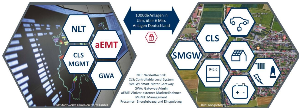
Abbildung 1 Übersicht über die beteiligten Komponenten bei der Einbindung von dezentralen Einspeisern und Lasten
