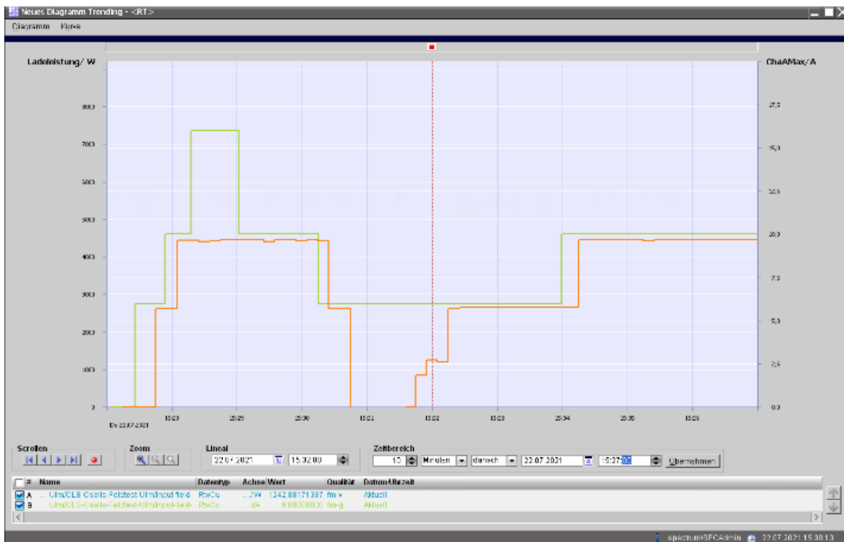
Abbildung 16 Visualisierung der Steuerung des Ladeparks durch die experimentelle Verteilnetzleitwarte der THU (kontrollierte Begrenzung der Ladeparkleistung in grün; tatsächlich genutzte Ladeleistung in orange)
