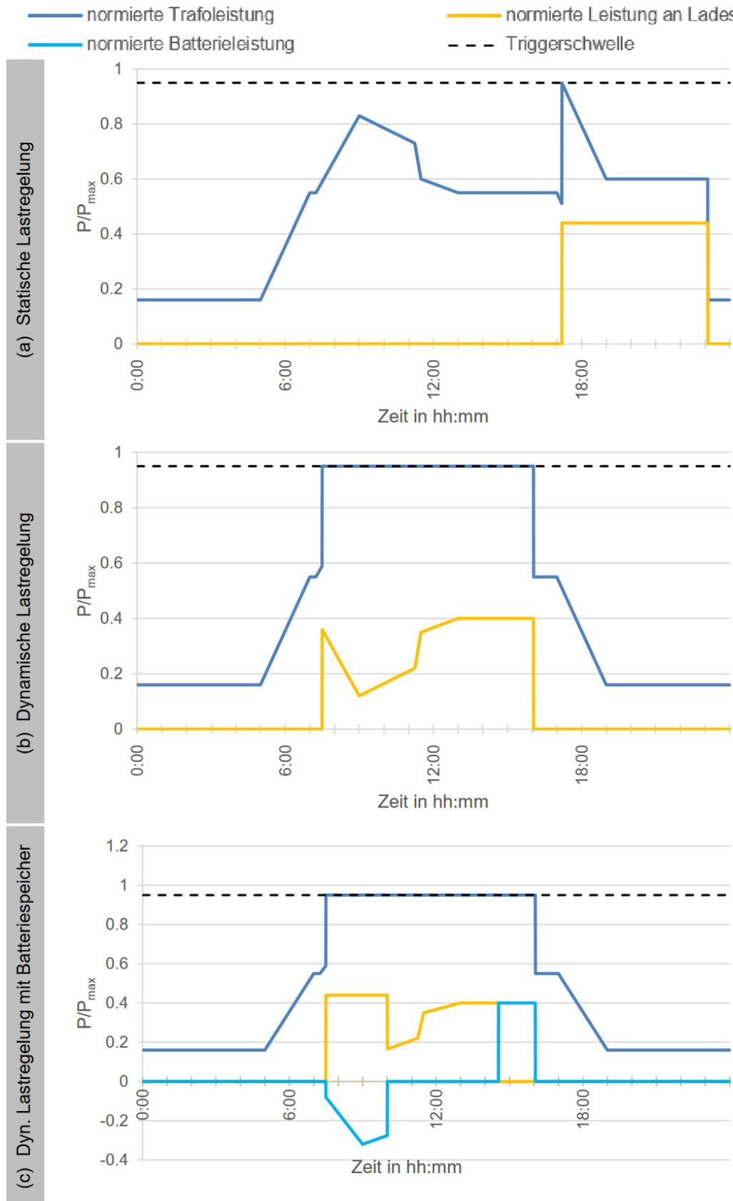
Abbildung 3-8: Auswirkungen des Grenzlastbetriebs für die verschiedenen Regelungsverfahren.
