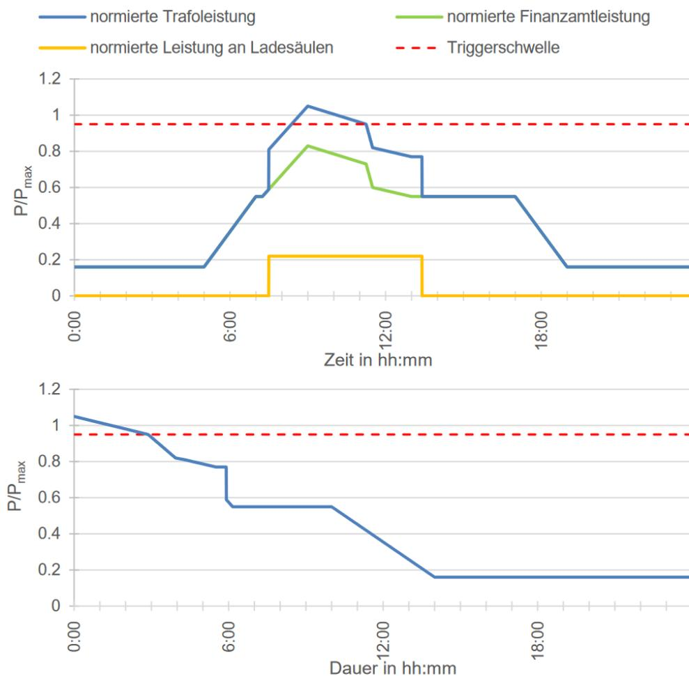
Abbildung 3-3: Lastverlauf am Transformator für den Normalbetrieb mit Überlast ohne Regelmaßnahme (oben). Tagesdauerlinie für den Überlastbetrieb ohne Regelmaßnahme (unten).
