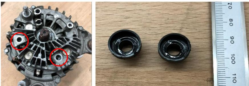
Abbildung 66: links – Lichtmaschine Typ L2 ohne Kunststoffhülsen; rechts – Kunststoffhülsen
