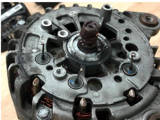
Abbildung 70: Lichtmaschine Typ L2 ohne Kunststoffabdeckung für Leitungen
