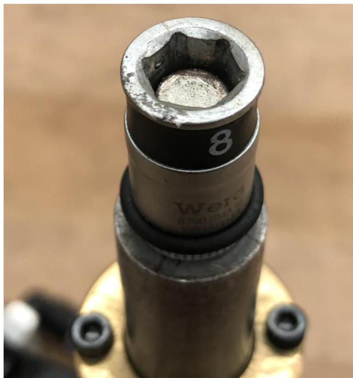
Abbildung 14: Magnetische Schrauberruss, Schlüsselweite 8
