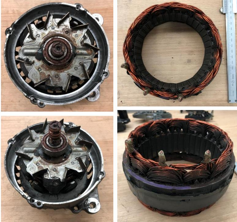
Abbildung 73: links - Lichtmaschine Typ L2 ohne Stator; rechts – Stator
