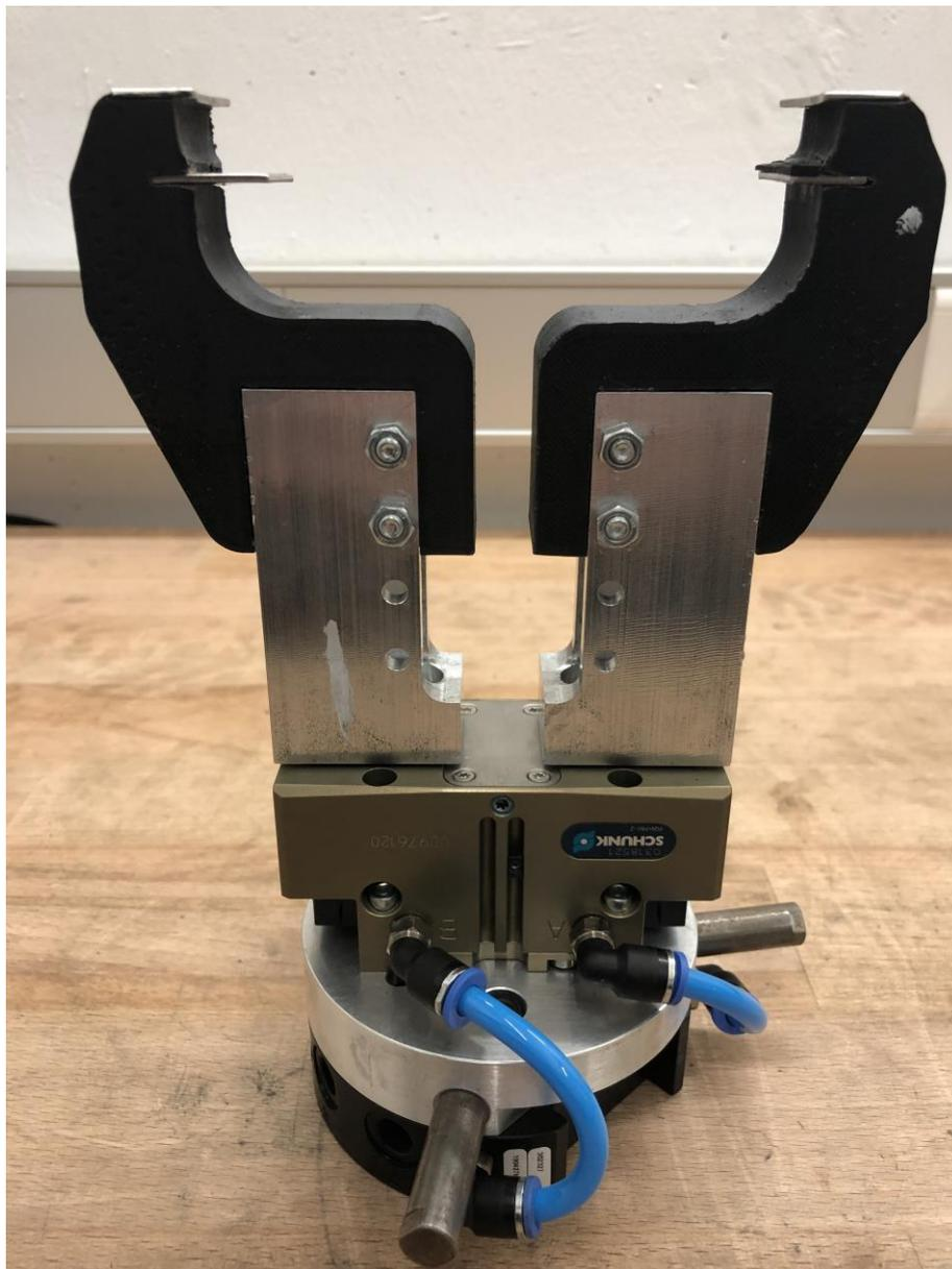
*Abbildung 24: Kombiniertes Greifer für die Gleichrichterdiodeplatte
