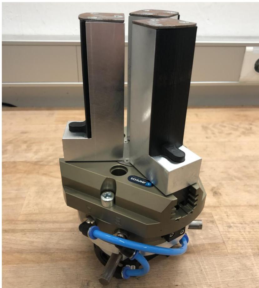
*Abbildung 26: Statorgreifer mit wechselbaren Kunststoffauflagen und stirnseitigen Stahlblechen*
