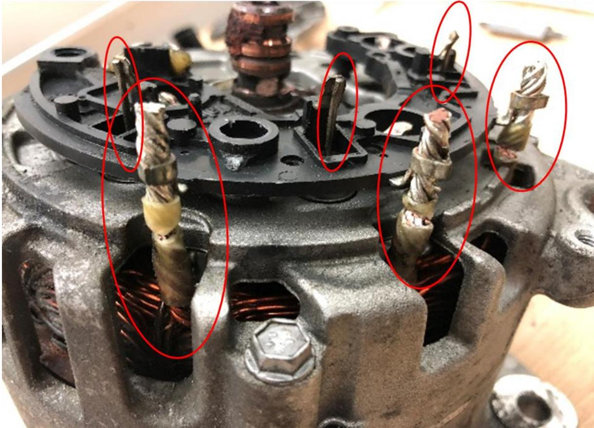
*Abbildung 16: Lötverbindungen zwischen Statorwicklung und Diodenplatte*
