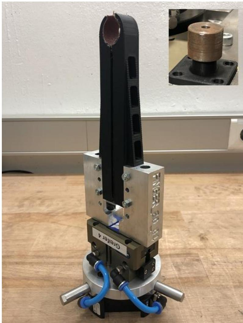
*Abbildung 25: Greifer für die adaptierende Stahlbuchse des Austreibestempels (oben rechts im Bild) mit ausgekleideten Greifflächen*
