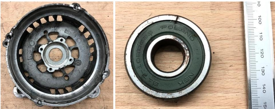
Abbildung 76: links – Antriebslagerschild; rechts – unteres Kugellager
