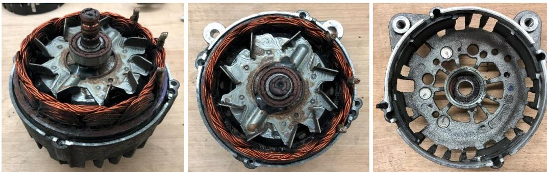
Abbildung 72: links - Lichtmaschine Typ L2 ohne Schleifringlagerschild; rechts – Schleifringlagerschild
