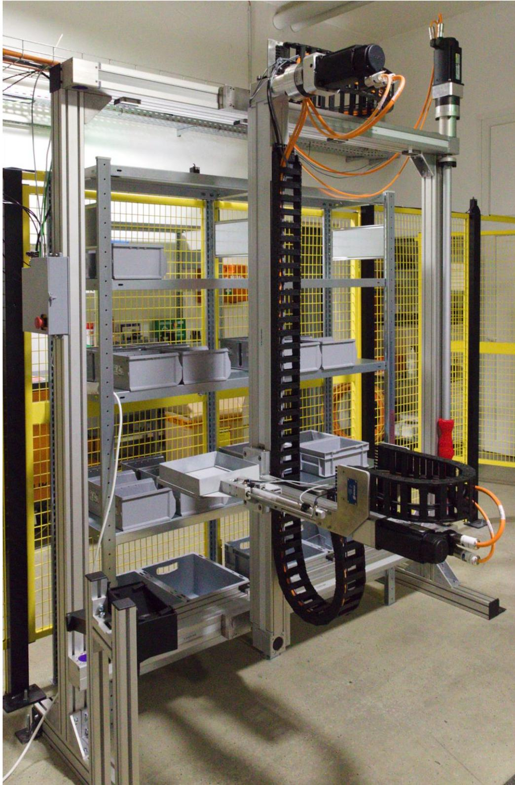
*Abbildung 28: Automatisiertes Ablagesystem zum Einsortieren der demontierten Bauteile*
