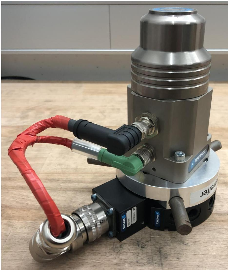
*Abbildung 27: Magnetgreifer mit Stromversorgung und Signalleitung, montiert auf einem SWA-076 der Firma Schunk*
