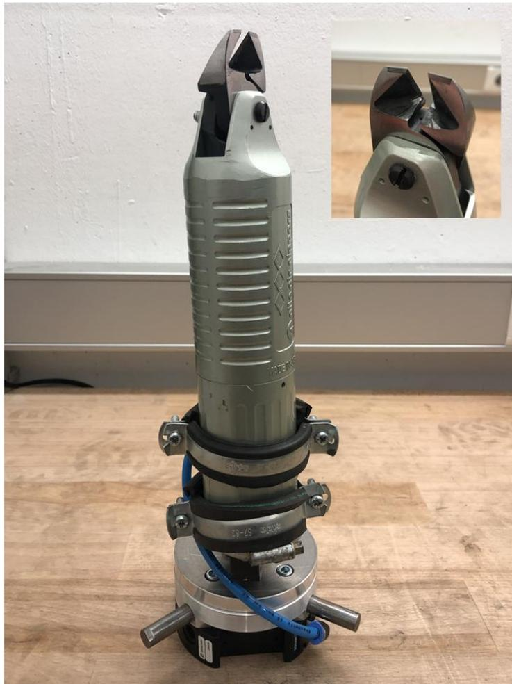
*Abbildung 17: Mit Schlauchschellen befestigte pneumatische Schneidzange (Hauptbild),
