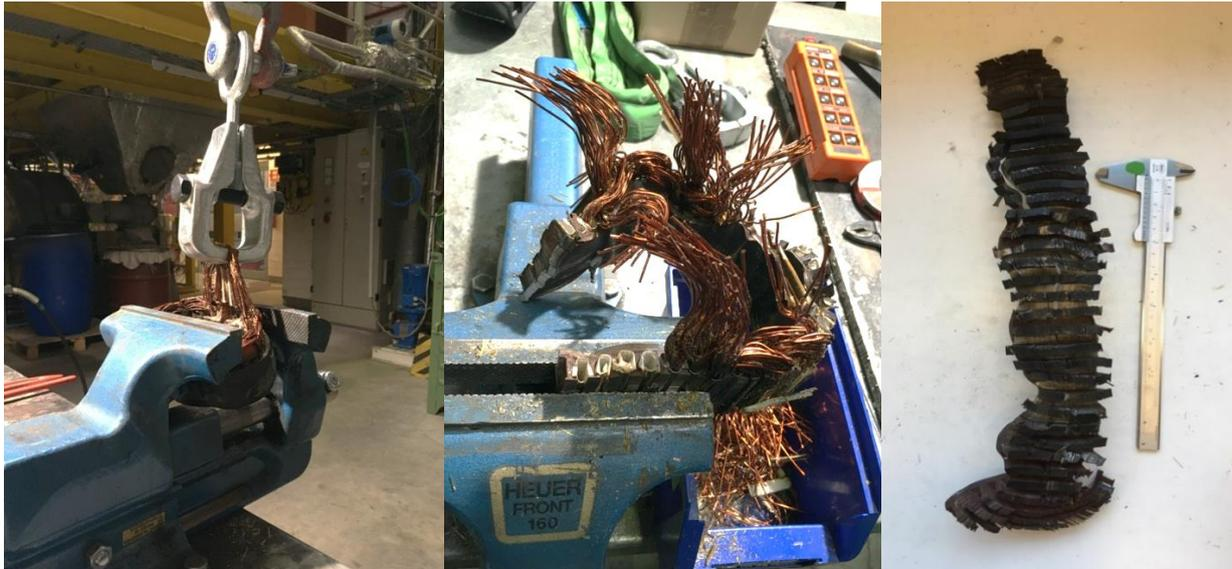
*Abbildung 56: Beispielhafter manueller Demontageschritt des verbauten Stators zur Trennung von Blechpaket und Kupferwicklung (links & Mitte), Blechpaket des Stators vor der Analyse (rechts)*
