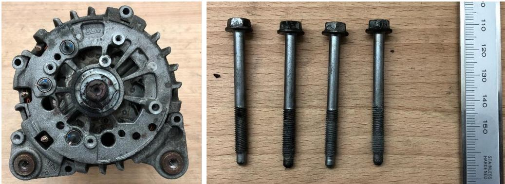
Abbildung 71: links – Lichtmaschine Typ L2 ohne Verbindungsschrauben; rechts – M5x52SW8
