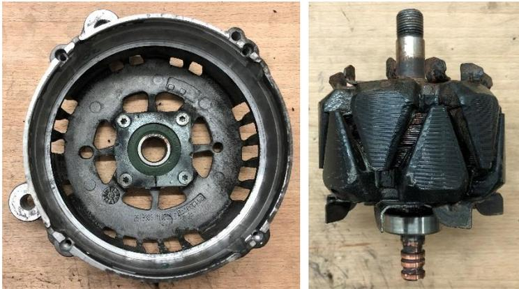
Abbildung 74: links – Schleifringlagerschild; rechts – Rotor
