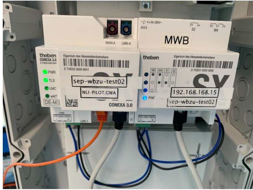
Abbildung 31: Aufbau vom Testsystem 02 mit vorkonfigurierten SMGW und CLS-Gateway zur Integration von lokaler Lade-Infrastruktur in das Heimenergiemanagementsystem und zur Anbindung an lokale Marktplätze.
