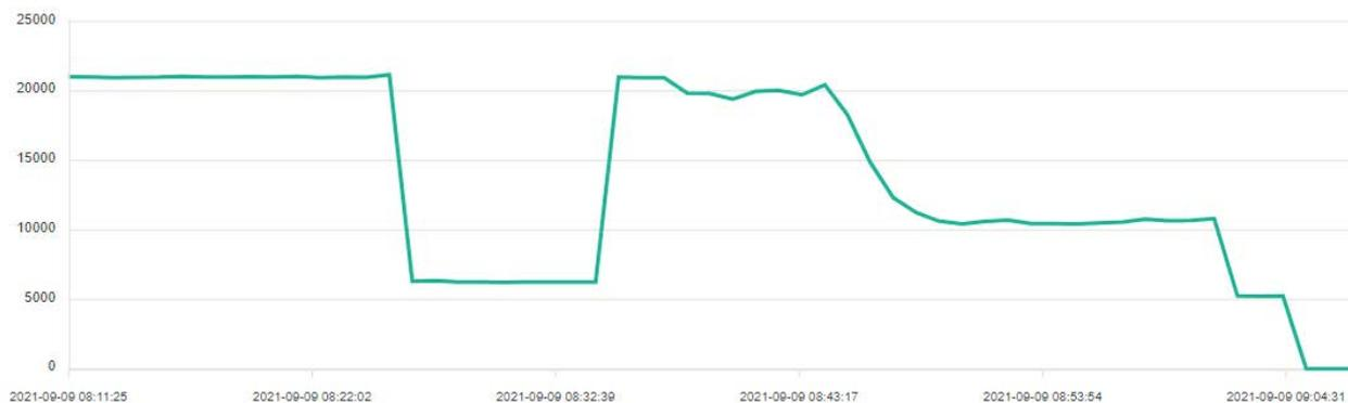
Abbildung 47: Darstellung einer Ladetransaktion eines Fahrzeuges während des Stresstests
