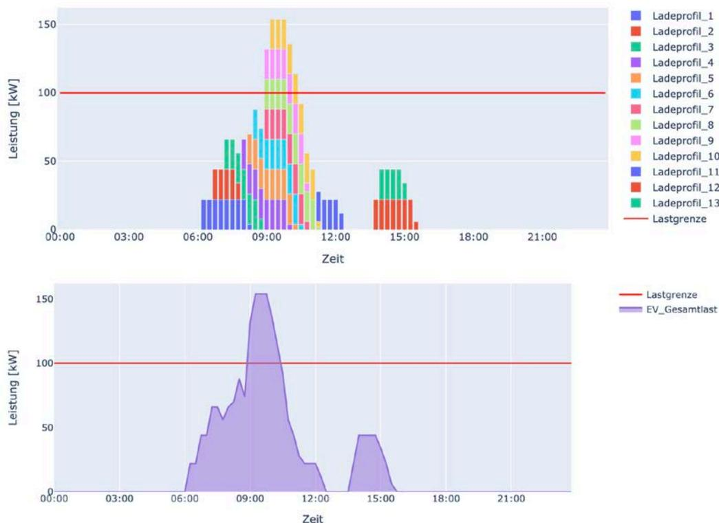
Abbildung 67: Unkontrollierte Lastkurven für den Anwendungsfall Parkhaus Wizemann Areal mit Beispiel Lastgrenze 100 kW
