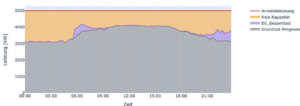
Abbildung 72: Ladeoptimierung mit der Grundlast-Prognose von Marquardt
