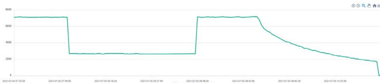
Abbildung 44: Lademanagement bei einem zweiphasigen Fahrzeug
