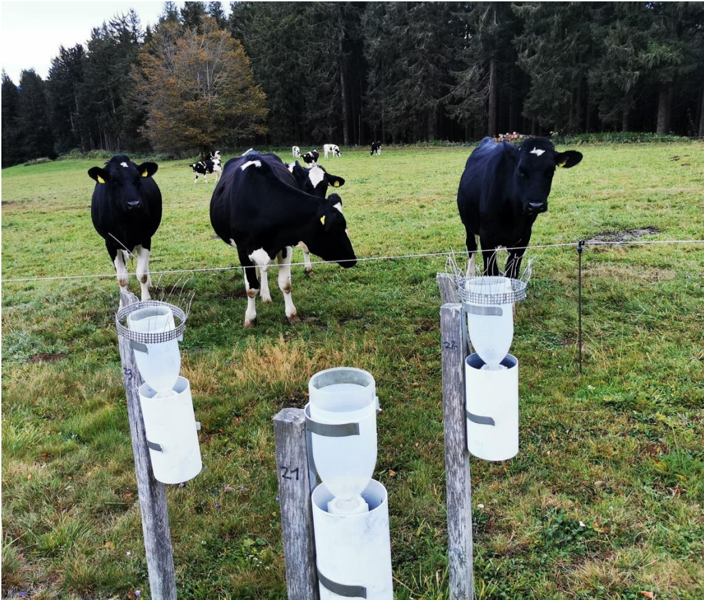
Abbildung 2-8: FVA-Freilandsammler. Die Kühe sind durch einen mobilen Elektrozaun vom Messfeld getrennt, Aufnahme vom 04.10.2020
