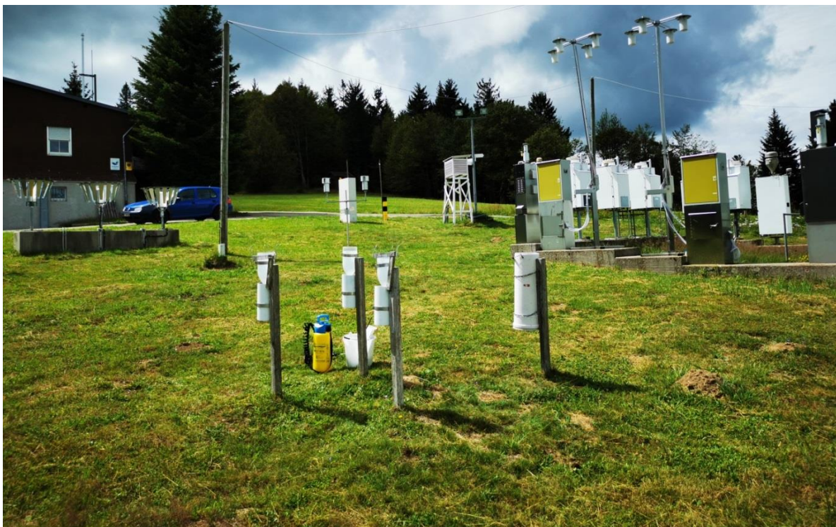
Abbildung 2-7: Im Vordergrund FVA-Freiland- und Schneesammler, dahinter UBA-Gebäude und -Messfeld
