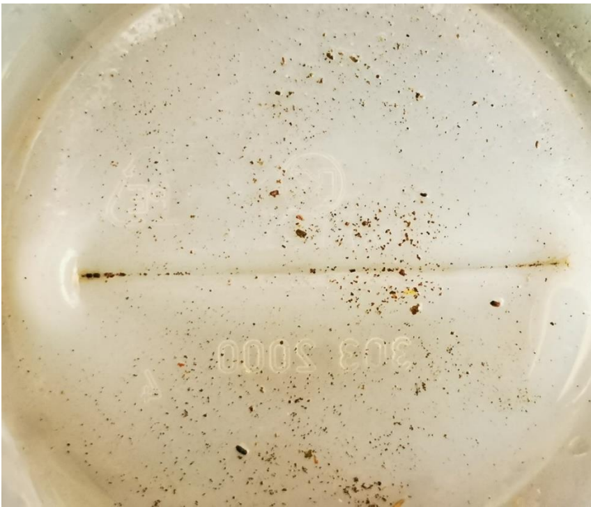
Abbildung 2-6: Typischer Bodenbelag im Bestandessammler nach 14-tägiger Verweildauer im Gelände
