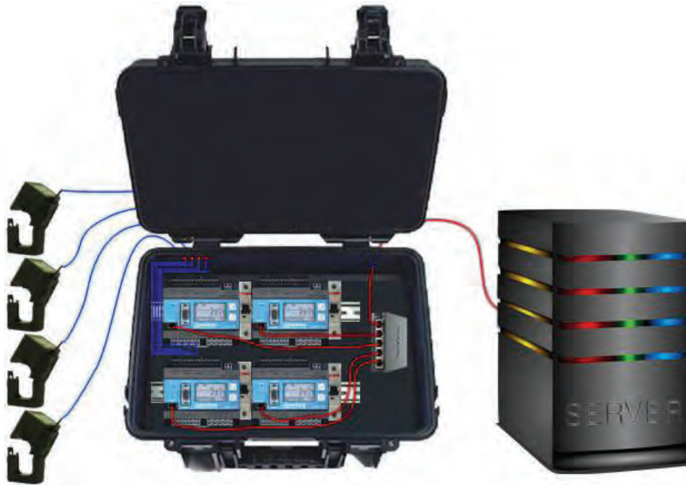
Abbildung 3-4: Schematische Darstellung des aufgebauten Messkoffers
