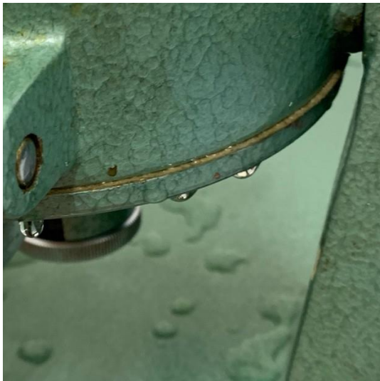
Abbildung 33: Austreten von Wasser beim Cobb-Test
