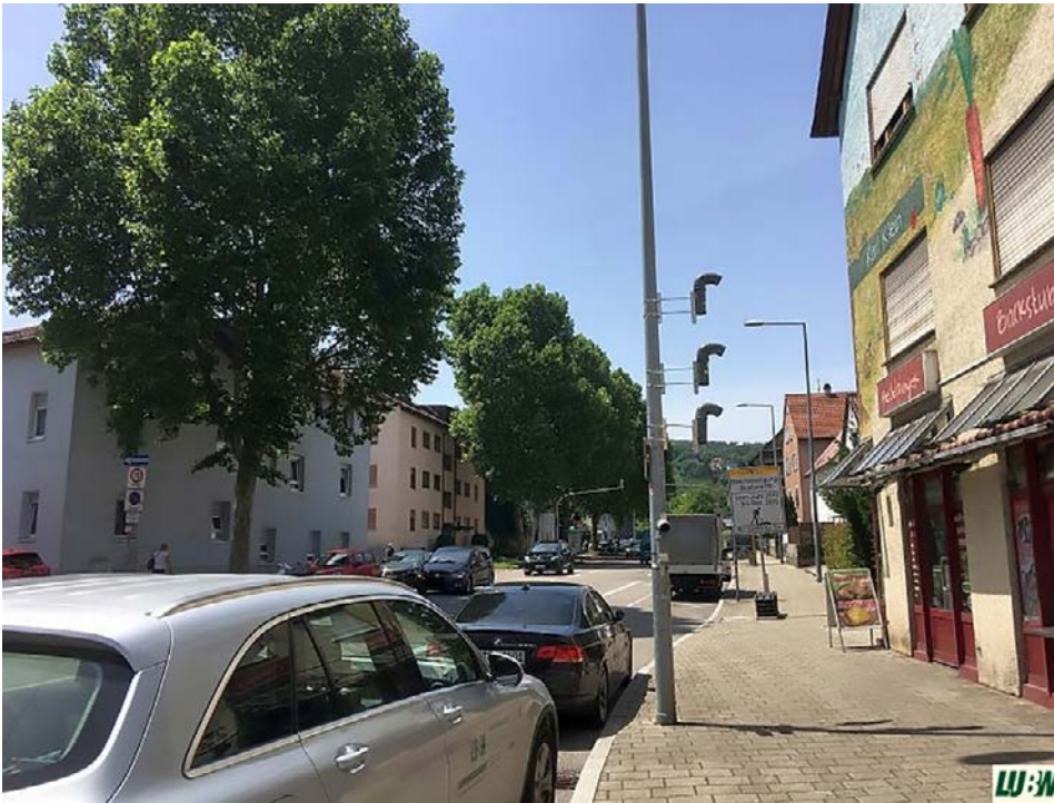
Abbildung 4.10: Beispielhafter Messaufbau bei den Höhenprofilmessungen
