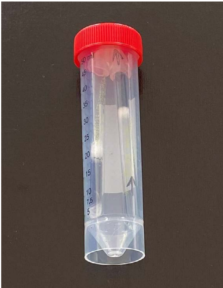
Abbildung 2.6: Adsorptionsröhrchen für die Sammlung von Quecksilber in Umgebungsluftproben. Links: Röhrchen im Transportgefäß, rechts: entnommenes Röhrchen. Um Probendurchbrüche zu vermeiden, werden zwei Röhrchen hintereinander geschaltet
