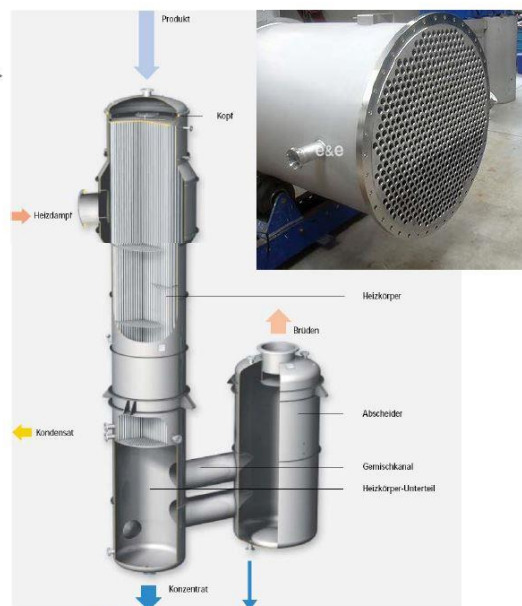
Abbildung 2-19: Verdampfer zur Aufkonzentrierung [Feistel, 2021]
