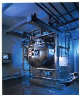
Abbildung 2-19: Verdampfer zur Aufkonzentrierung [Feistel, 2021]
