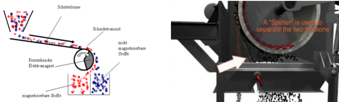
Abbildung 3-3: Trommelmagnet-Abscheider. Prinzip-Schaubild (links) Foto einer Anlage (rechts) (ERIETZ, Recklinghausen)
