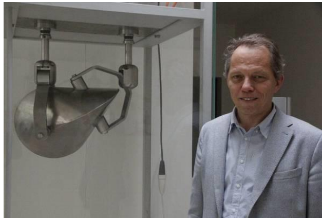
Abbildung 3-4: Oloid 600 als eigenständiges Mischgefäß/ Extraktionsbehälter (Bildquelle: Paul Schatz Stiftung, Basel [Inversionstechnik GmbH, Basel])
