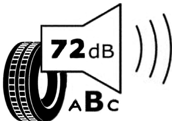
Abb. 7.2-4: Ausschnitt aus dem seit 1. Mai 2021 geltenden EU-Reifenlabel. An den fettgedruckten Großbuchstaben A, B, oder C und am dB-Wert lässt sich ablesen, wie laut der Reifen ist. A steht für eher leisere, C für lautere Reifen. Foto: D. Kaiser.
