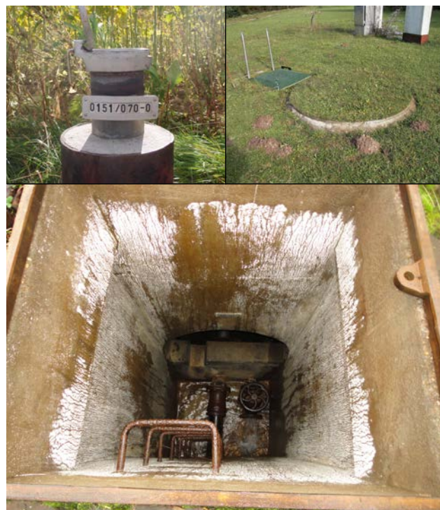
Abb. 5.1-2: Grundwassermessstelle, Lysimeter und Quelle (von links oben im Uhrzeigersinn). Foto: LUBW.
