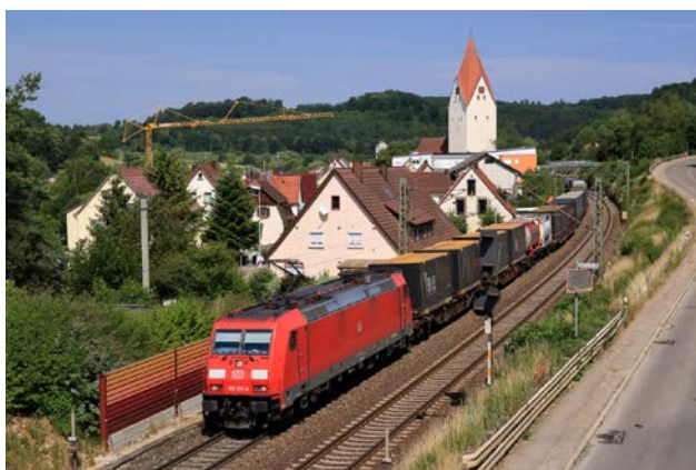
Abb. 7.2-7: Güterzug mit Lärmschutzwand. Foto: Deutsche Bahn AG.
