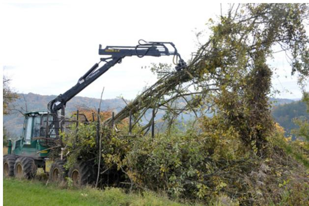
Abbildung 4.5: Ein Forwarder transportiert Vollbäume zum Häckselplatz. Diese stammen aus der Entbuschungsmaßnahme eines Trockenhangs bei Radolfzell. Die Wiederherstellung blumenbunter Wiesen ist hier das Ziel. Bildnachweis: Landschaftserhaltungsverband Konstanz
