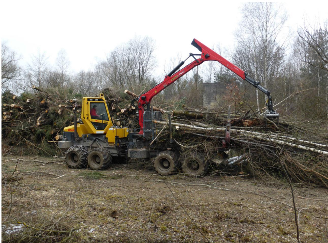
Abbildung 4.1: Entbuschung einer nahezu verwaldeten ehemaligen Kiesgrubenfläche des flächenhaften Naturdenkmals Kiesgrube Fließ in Singen. Der Forwarder transportiert mit seiner Klemmbank die gesamten Vollbäume aus der Fläche und bringt sie zum Platz, auf dem sie zu Hackschnitzeln verarbeitet werden. Dadurch verbleibt kein Material auf der entbuschten Fläche. Bildnachweis: Landschaftserhaltungsverband Konstanz
