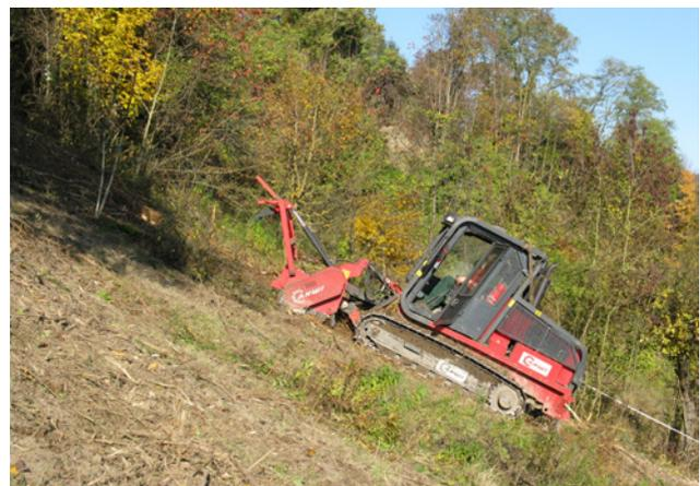
Abbildung 4.7: Raupenmulcher bei einer Entbuschungsaktion bei Radolfzell. Ziel ist hier die Wiederherstellung blumenbunter Wiesen. Hierzu wird auf der Fläche eine Beweidung etabliert werden. Bildnachweis: Landschaftserhaltungsverband Konstanz
