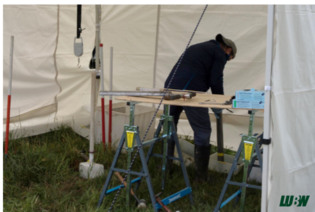
Abbildung 2.5: Entnahme eines Bohrkerns aus dem Split-Tube-Bohrer, (Foto LUBW 2018)
