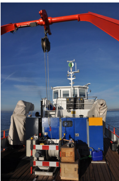
Abbildung 5.14: Der Kompressor (blau) für die seismischen Untersuchungen auf dem Arbeitsdeck der Kormoran liefert die Druckluft für einen „Schuss“ mit der Luftkanone, die an einer Boje hinter dem Schiff geschleppt wird (rechts). Bildquelle: LUBW.
