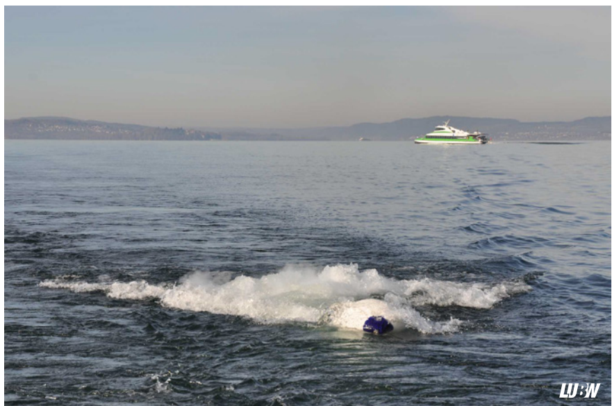
Abbildung 5.14: Der Kompressor (blau) für die seismischen Untersuchungen auf dem Arbeitsdeck der Kormoran liefert die Druckluft für einen „Schuss“ mit der Luftkanone, die an einer Boje hinter dem Schiff geschleppt wird (rechts). Bildquelle: LUBW.
