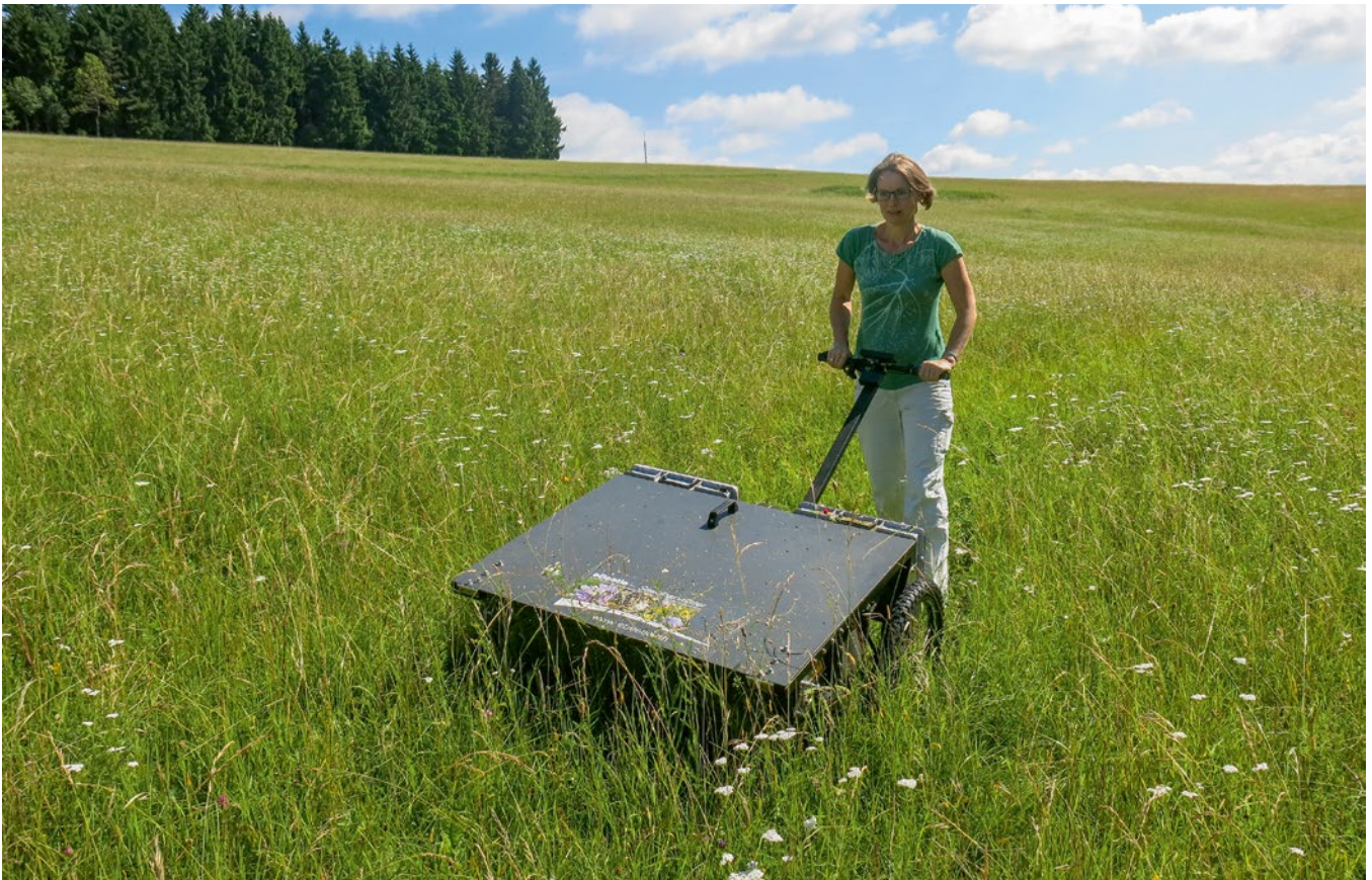
Samenernte mit dem eBeetle, einem elektromotorbetriebenen sogenannten Seed-Harvester.
