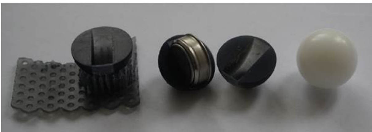
Abbildung 52: Temperatursensoren zur Messung der Temperatur innerhalb der Kugelpackung, links: Kugelhalbschale mit Vertiefung für den Sensor nach der Herstellung, Mitte: Kugelhalbschalen mit eingelegtem Sensor, rechts: Kugel aus Kugelpackung zum Vergleich
