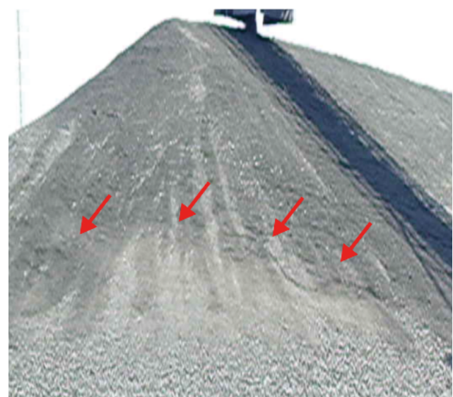
Abbildung 5.2: Staubemission beim Abwurf eines Schüttguts auf eine trockene Halde. Staubemissionen entstehen durch Abrieb (rote Pfeile). Quelle: IMA, 2007.
