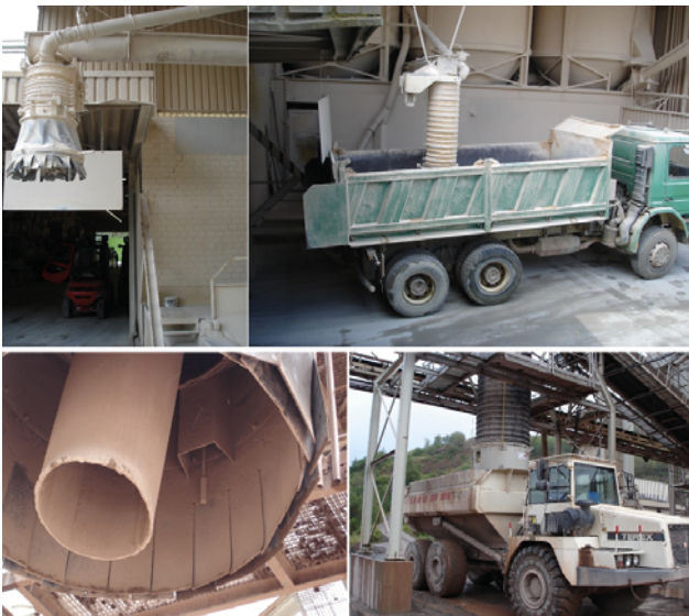
Abbildung 5.5: Beispiele für absenkbare Verladeköpfe. Fotos: iMA, 2007. Oben links ist das Fallrohr eingefahren, in Aktion (oben rechts) abgesenkt. Unten links ist das Fallrohr (Mitte) und das Absaugrohr (außen) erkennbar.
