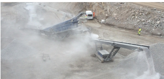
Abbildung 5.1: Einfluss von Befeuchtungsmaßnahmen an einer Aufbereitungsanlage. Links: ohne Befeuchtung. Rechts: mit Befeuchtung. Quelle: Klenk et al., 2016.
