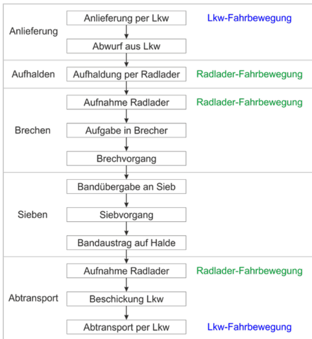
Abbildung 4.1: Staubemittierende Vorgänge einer typischen Bauschuttrecyclinganlage.
