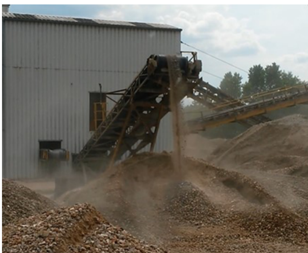
Abbildung 5.4: Einfluss des Massenstroms auf die Staubentwicklung. Quelle: iMA, 2016.
