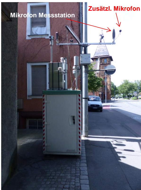
Abbildung 31: Messstation mit zusätzlichem Mikrofon
