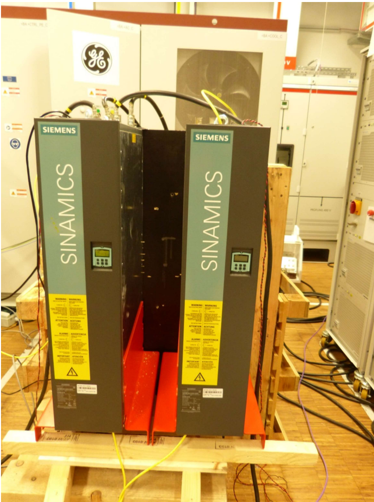
Abbildung 9: Laboraufbau für den Betrieb von zwei DCP 120.
