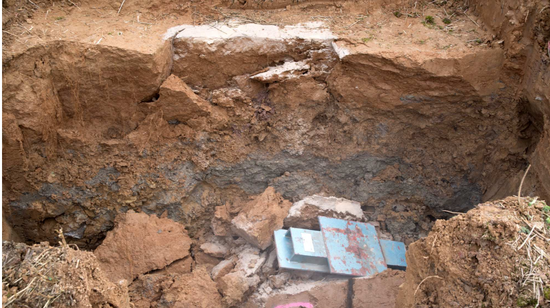
Abbildung 5: Bruchform beim in situ-Scherversuch; nach dem Bruch wird die Geometrie des Bruchkörpers ausgemessen
