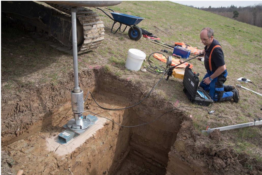
Abbildung 2: Aufbau des in situ-Scherversuchs (Durchführung: Henke und Partner GmbH, Stuttgart)
